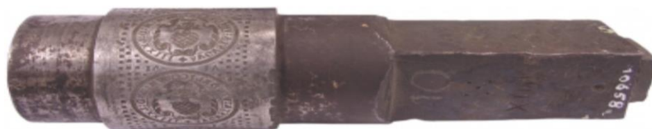
Rodillo de Walzenwerke empleado para acuñaciones de moneda local en la ceca de Augsburgo, en 1573. (foto: de Glenn Murray: Asociación Amigos de la Casa de la Moneda de Segovia).
