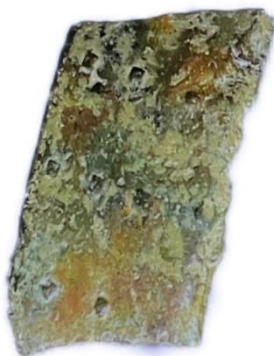
Foto 3. Riel recortado (lámina) del Real Ingenio de la Moneda de Segovia, en los primeros procesos de laminación (nótese el gran grosor de 4 mm) con marcas de arrastre para facilitar el tránsito del metal entre los rodillos. Fiel muestra de que en los procesos laminadores también se utilizaban estas marcas, cuando el riel iba destinado a ser labrado posteriormente por rodillos. Colección privada. Foto del autor.
