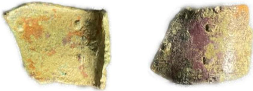
Riel sin marcas de dilatación tanto en anverso como en reverso. Pertenece a primeras laminaciones. Restos de empaste generados seguramente por las impurezas del metal. Imagen propiedad del autor.
