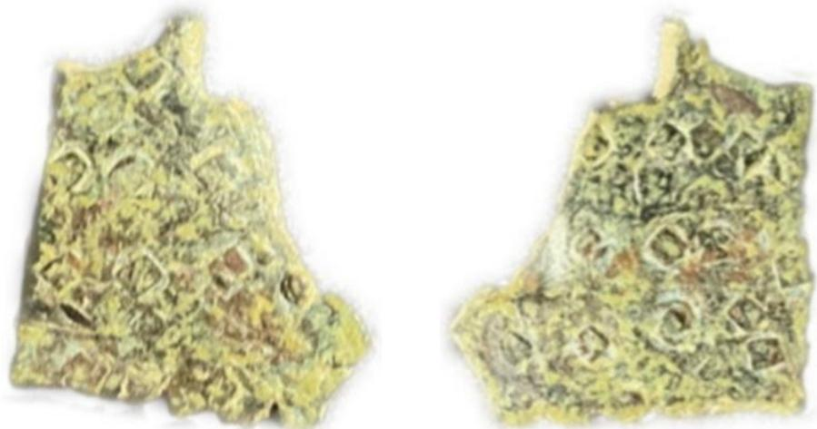
El anverso y el reverso poseen marcas de dilatación de una manera irregular. Lo que indica que fue pasando varias veces entre rodillos de laminación con las susodichas improntas.
