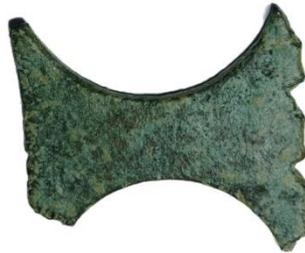
Foto 5. Cizalla de riel destinado a sacar flanes para prensa a volante. Imagen del autor.
