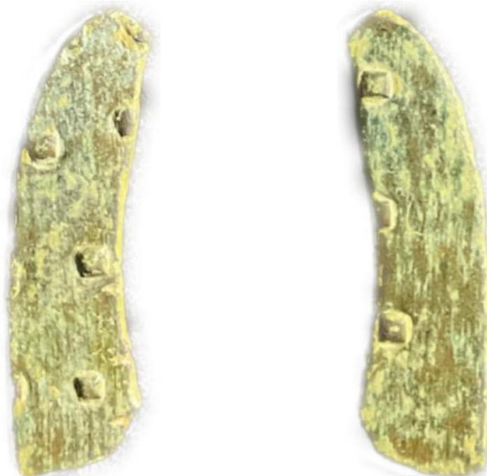
Recorte de riel con marcas de dilatación. La textura del mismo nos indica que se usó para labra a molino, por el tamaño de las marcas de arrastre, y el grosor del metal, este riel seguramente estaba en los primeros procesos de laminado. Imagen propiedad del autor.
