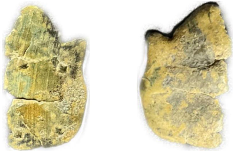
Riel en los primeros procesos de laminación. En anverso se ven marcas de dilatación, el reverso sin abarco se laminó con rodillo liso, de ahí que se aprecie la expansión del metal. Seguramente este riel iba destinado a labra por rodillo. Imagen propiedad del autor.
