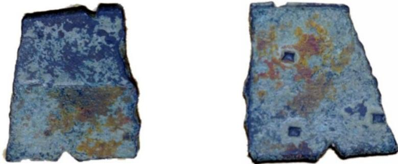
Riel en sus primeros procesos de laminado. Se observa, que en estos primeros aplastamientos, los rodillos tenían marcas de dilatación para controlar la expansión del metal. Riel seguramente destinado a ser labrado por reales Ingenios. Imagen propiedad del autor.
