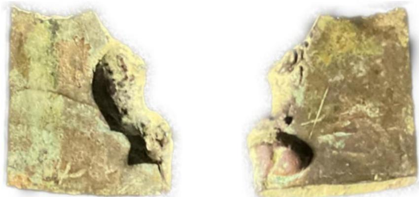
Cizalla en los primeros pasos de laminación. Todavía conserva un pegote de cobre de la fundición en la lingotera. Usado para extraer cospeles y acuñarlos en prensa volante. Imagen propiedad del autor.
