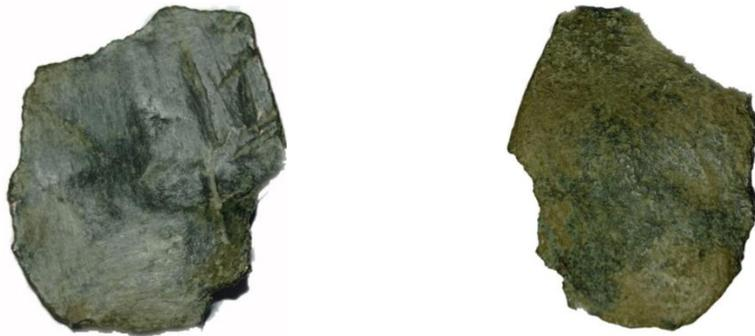
Trozo de cizalla con diferentes marcas por presión de los rodillos en el proceso del laminado. Imagen propiedad del autor.
