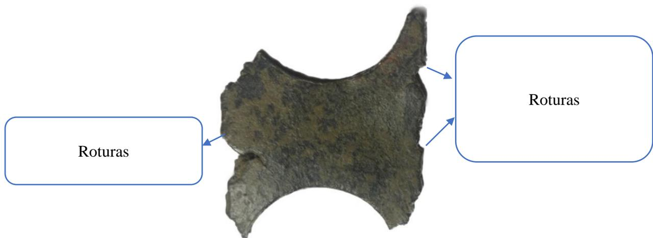
Foto 4. Dos recortes en el riel, adelgazado por prensas de laminación. Los flanes fueron extraídos con tórculo para confeccionar moneda por prensa a volante. Nótese las irregularidades en los laterales de la plancha, efecto de la presión de los rodillos de laminación o tal vez del recorte. Colección privada. Imagen del autor.
