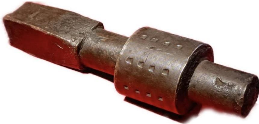
Foto 13. Rodillos laminador con marcas de arrastre colocadas linealmente y en distribución paralela. Casa de la moneda de Potosí<sup>12</sup>. Foto Murray, Glenn. "Tecnología de la Acuñación. Laminación de Metal". Segoviamint. org.
