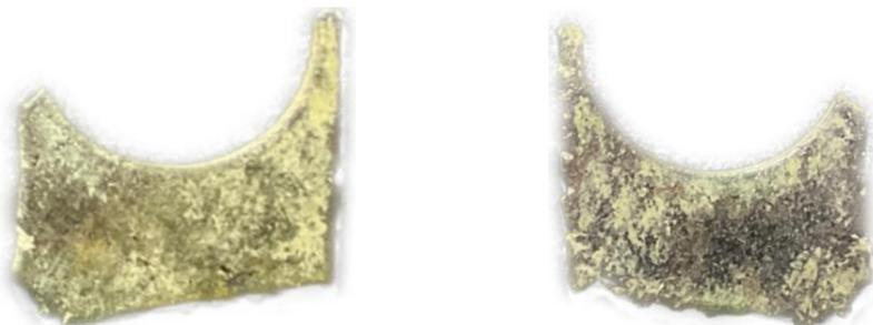
Riel con vano. Seguramente usado para sacar cospeles y su posterior labra con prensa de Volante. Encaja por tamaño en un 4 maravedís borbónico. Imagen propiedad del autor.
