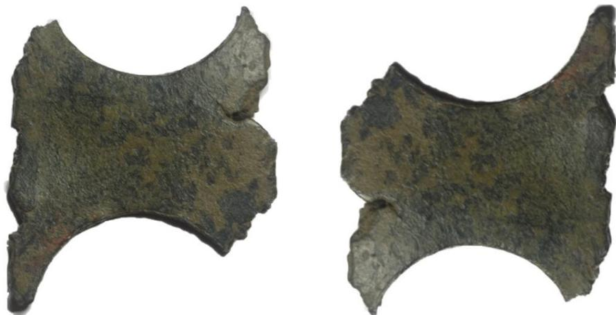
Cizalla con dos recortes. Riel destinado a sacar cospeles para ser acuñados en prensa de Volante. Imagen propiedad del autor.
