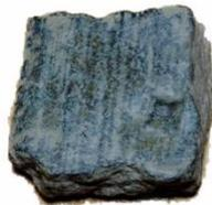
Foto 10. Cizalla con grosor grande, con marcas de arrastre improntadas por los rodillos de laminación. Colección privada. Imagen del autor.
